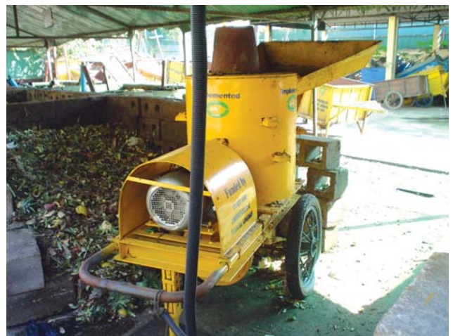
Community compost shredding ម៉ាស៊ីនគិតសំរាមសរីរាង្គធ្វើជីកុំប៉ូសសហគមន៍
